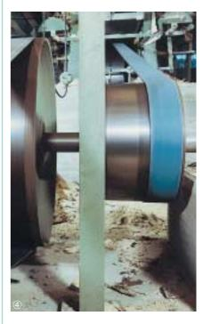
④ Für Gatter, Hacker und Zerspaner sind Extremultus Hochleistungs-Flachriemen erste Wahl in bezug auf Betriebssicherheit, Gleichlaufgenauigkeit und Wirkungsgrad.
